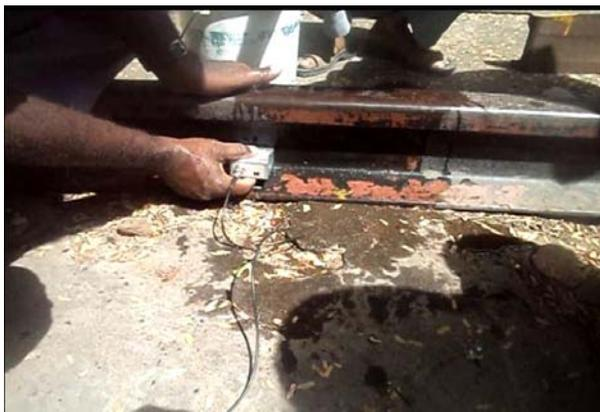
5.3.1 . Fig . ultrasonic test
